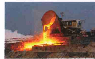
Versement des laitiers d'aciérie de conversion LAC en fosse.
